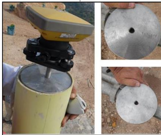
Figura 62. Plato de acero de 1" x 6" (rosca hembra en el centro de 5/8"). Recuperado de: Elaboración propia.
