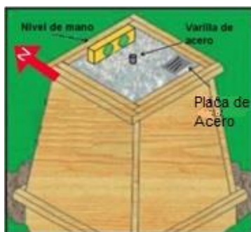
Figura 50. Nivelación de la superficie del monumento. Recuperado de: Elaboración propia.
