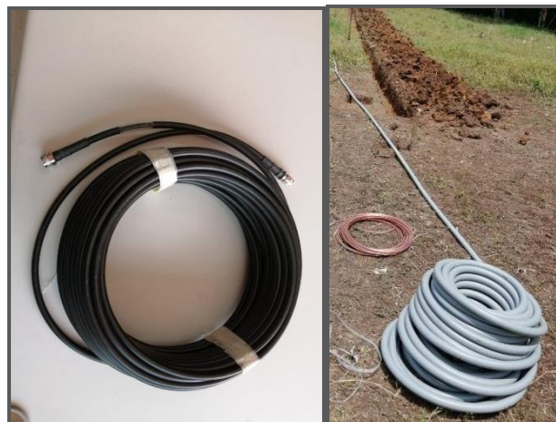
Figura 11. Materiales, Cable Coaxial, Coraza, Cable de cobre descubierto. Ilustración de trabajo conjunto SGC – IGAC.
