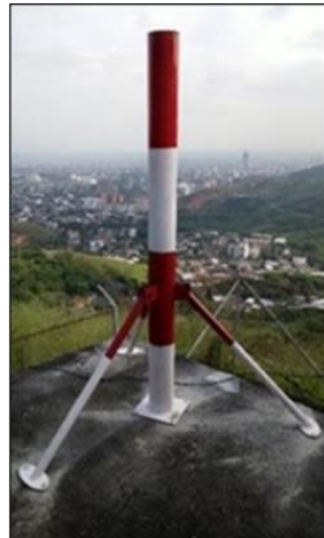
Figura 65. Materialización tipo Mástil terminada. Recuperado de: Elaboración propia.
