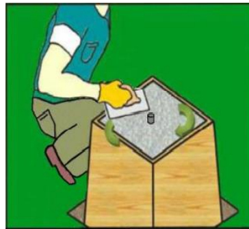
Figura 67. Acabado del concreto. Recuperado de: Elaboración propia.
