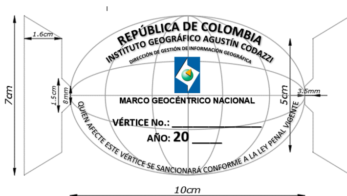
Figura 3. Diseño de la placa de acero inoxidable utilizada para la identificación de vértices geodésicos (IGAC 2021). Recuperado de: Elaboración propia.
