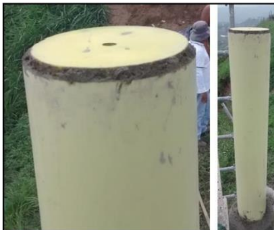
Figura 63. Plato de acero de 1" x 6" (rosca hembra en el centro de 5/8"). Recuperado de: Elaboración propia.
